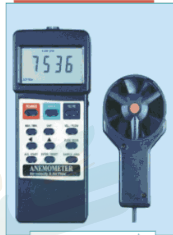
الأنيمومتر لقياس سرعة الرياح
